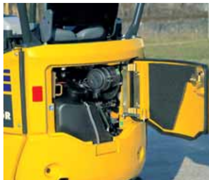
Capot arrière: contrôle rapide des éléments du moteur et remplissage gasoil
